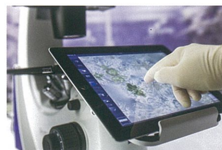
Primovert HDcamはフロントホルダーに iPad等のモニターを設置可能。
